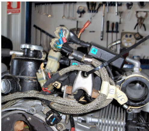
Fotografía 6. Módulos electrónicos instalados en el motor original
